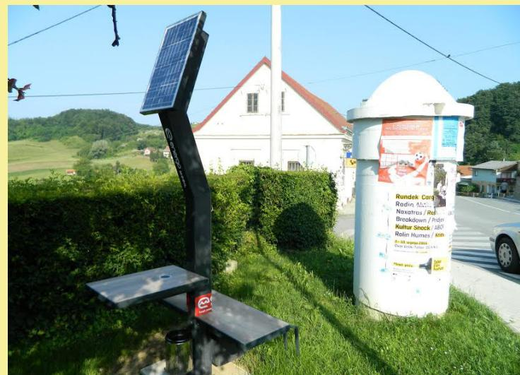
Park na Trgu sv. Jurja postao je bogatiji za odmorištu za bicikle. Odmorište podrazumijeva Solarni set Intego - uključuje klupu za sjedenje, stol, koš za smeće, dva stalka za bicikle, USB utičnice za mobitel ili tablet, fotonaponski panel od 40 W, regulator napona
